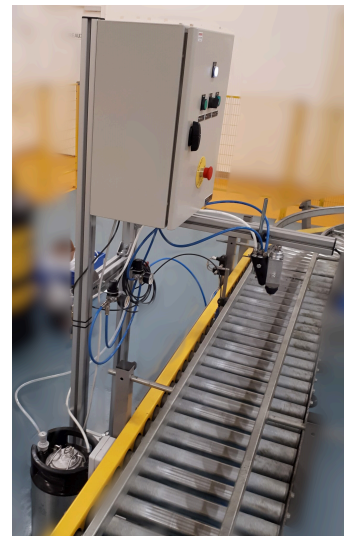
Application automatisée du Stabilisateur AZ
